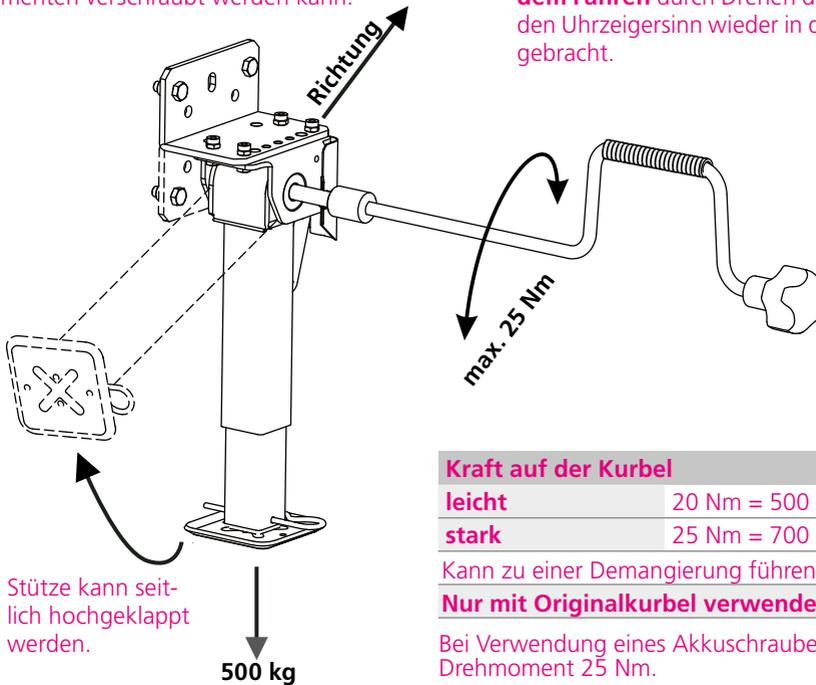
Stütze kann seitlich hochgeklappt werden.
