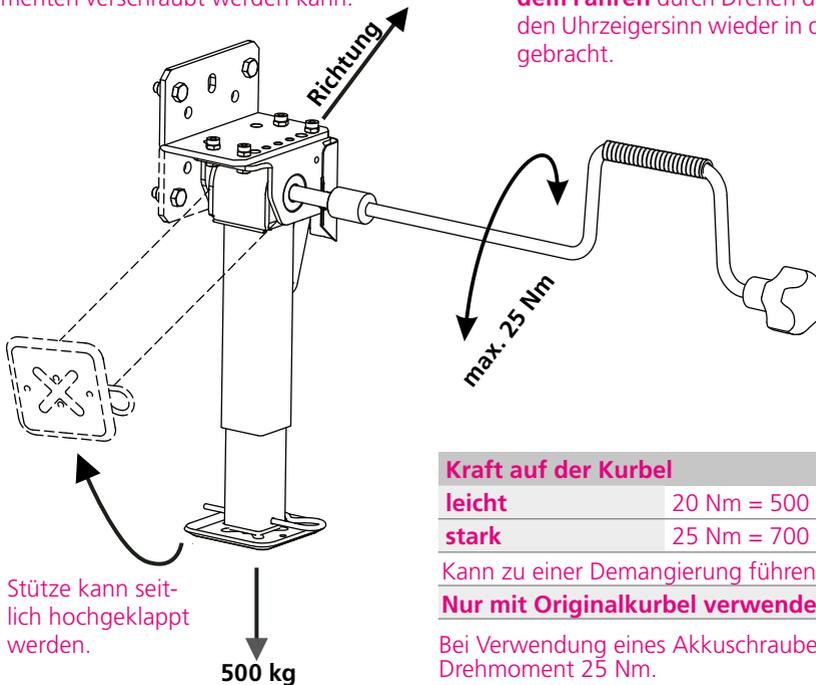
Stütze kann seitlich hochgeklappt werden.
